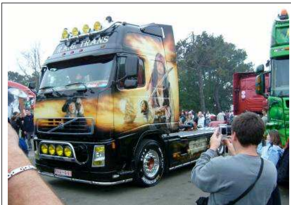
C'est une photo d'un camion tuning. Cette peinture a été faite avec une bombe à peinture avec des pochoirs pour les dessins et aussi avec le pistolet à peinture.
