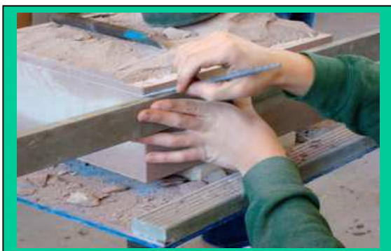
Les gestes du tailleur de pierre sont précis : ici il trace la bonne mesure.
